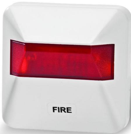
ریموت اندیکاتور R1-ARI-300 یک هشداردهنده دیداری برای اعلان محل وقوع آتش می‌باشد. این امکان با دارا بودن شدت نور بالا به لوب سیستم آدرس پذیر وصل شده و قادر است در حالت آتش‌سوزی وجود دود کارایی مناسبی داشته باشد و به کاربر محل آتش را نشان دهد. در یک سیستم آدرس-پذیر، قابلیت آدرس دهی، زون‌بندی و مشخص کردن محل نصب نشانگرهای ریموت وجود دارد.
