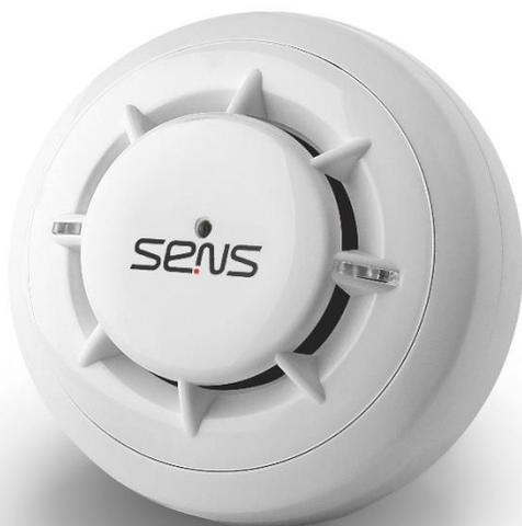
دتکتور مولتی مدل S2-CMD-200 یک محصول مولتی سنسور است که در واقع ترکیب دتکتور دودی و حرارتی- دما ثابت می‌باشد. این المان با استفاده از پدیده شکست نور، دود موجود در محیط و توسط سنسور حرارتی، دمای محیط را سنجش می‌کند و در صورت وقوع آتش سوزی اعلان حریق می‌نماید.
