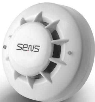
دتکتور حرارتی مدل HD-101 دمای محیط را پایش کرده و در صورتیکه دمای محیط بالای ۶۲ درجه سانتی‌گراد برسد، وضعیت حریق را به مرکز کنترل گزارش می‌کند. این دتکتور برای مکان‌هایی که ممکن است در شرایط عادی، تغییرات دمایی و مواد دودزا در آن‌ها وجود داشته باشد، مناسب است.
