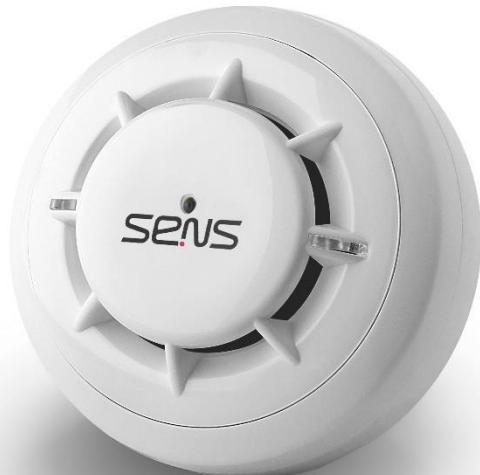
دتكتور S2-AMD-300 از نوع دتكتور مولتى سنسور آدرس-پذير است که در واقع ترکيب دتكتور دودي و حرارتى دما-ثابت می باشد. اين دتكتور با استفاده از پدیده شکست نور، وجود دود در محيط را تشخيص می دهد و با استفاده از سنسور حرارتى دمای محيط را اندازه گيري کرده و با عبور از مقدار تعیین شده، اعلام حريق می نماید. از اين رو اين دتكتور می تواند به منظور استفاده در محيظهاي مختلف گزينه مناسب باشد چرا که بطور همزمان دو فاكتور ناشی از حريق را بررسی می نماید.
