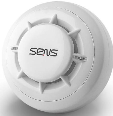
دتكتور آدرسپذیر حرارتی دما-افزایشی مدل S2-ARD-300 با قابلیت اندازه‌گیری دما و نرخ رشد آن، علاوه بر دمای محیط به نرخ افزایش آن نیز واکنش نشان داده و اعلام حریق می‌نماید. طراحی دتكتور بر اساس استانداردهای اروپا صورت گرفته است به گونه‌ای که با افزایش دما با نرخ رشد ۸ درجه سانتی‌گراد بر دقیقه فعال می‌شود. این دتكتور برای مکان‌هایی که در آن‌ها مواد دودزا در محیط وجود داشته باشد و همچنین برای محیط‌هایی که در صورت بروز آتش‌سوزی حریق به سرعت رشد می‌کند، مناسب می‌باشد.
