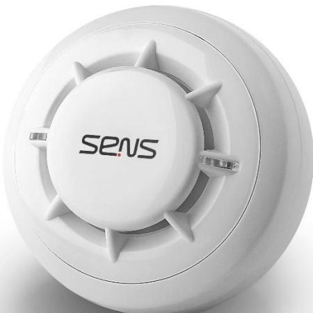
دتكتور حراري دما-ثابت آدرسپذير مدل S2-AHD-300 با استفاده از سنسور حساس به دما در صوريكه دمای محیط بيشتر از ۷۰ درجه سانتيگراد شود اعلن حريق را به مرکز کنترل گزارش مي‌نماید. اين دتكتور برای مکان‌هایی که در آن‌ها مواد دودزا در شرایط عادي وجود دارد، مناسب می‌باشد.
