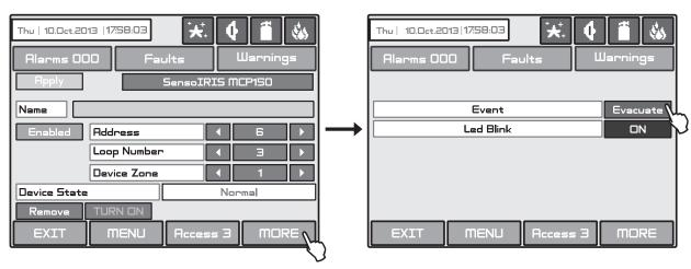
Fig. Screen 10(d) - SensolRIS MCP150 manual call point.
