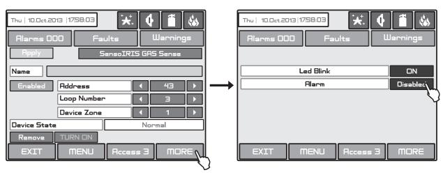
Fig. Screen 10(s) - SensolRIS GAS detector
