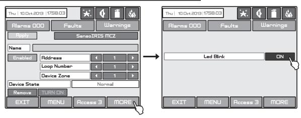
Fig. Screen 10(p) - SensolRIS MCZ module.
